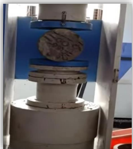
Fig.3 Split Tensile Test
