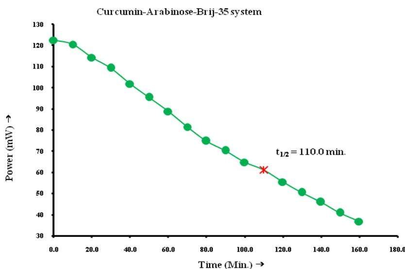
Fig. 4 TIME-POWER CURVE OF THE CELL
