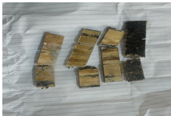
[Fig 8. Specimen after Izod test]
